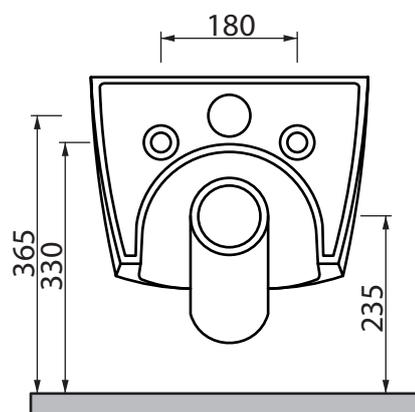
N.B.: Le misure indicate possono subire una variazione dello 0,8 % circa, dovuta ad usura degli stampi o a piccole variazioni delle caratteristiche tecniche relative alle materie prime che compongono l'impasto.
