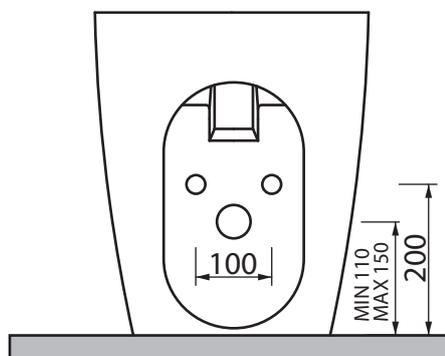
N.B.: Le misure indicate possono subire una variazione dello 0,8 % circa, dovuta ad usura degli stampi o a piccole variazioni delle caratteristiche tecniche relative alle materie prime che compongono l'impasto.
