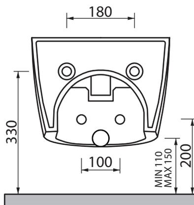
Le quote degli spazi per l'alloggio degli impianti idraulici sono indicative. Tenere conto delle tolleranze ceramiche, si consiglia di non lavorare al limite degli spazi utili indicati. Le quote si riferiscono al bidet installato ad una altezza, come da quota, di 420 mm da terra al bordo superiore.
